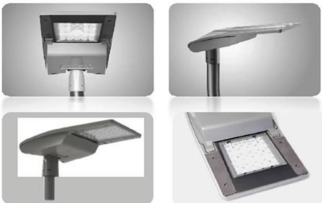
Per **facilitare** le attività di installazione e manutenzione, è possibile sganciare il vano ottico dalla struttura portante **senza l'ausilio di alcun utensile** e rimontarlo in un secondo momento. L'apparecchio è equipaggiato con un **sistema di sicurezza** che scollega elettricamente il vano ottico dal vano alimentazione quando l'apparecchio viene aperto, e lo ricollega quando viene chiuso.
