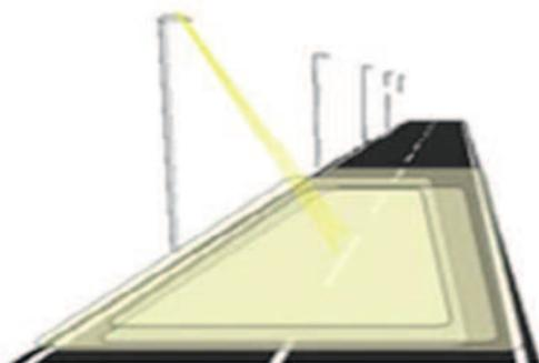
L'eventuale malfunzionamento di un chip LED porterà, grazie alla tecnologia **multi-layer**, ad una impercettibile riduzione percentuale del flusso luminoso, senza compromettere l'uniformità generale della strada.
