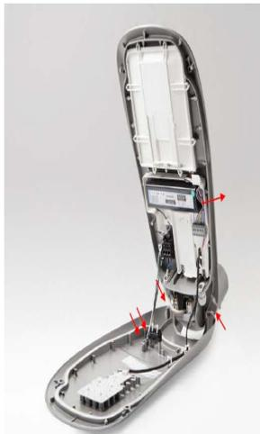
Il vano ottico può essere separato dalla struttura portante dell'apparecchio allentando le viti delle due cerniere installate nella parte posteriore e le due viti della staffa antiribaltamento.
